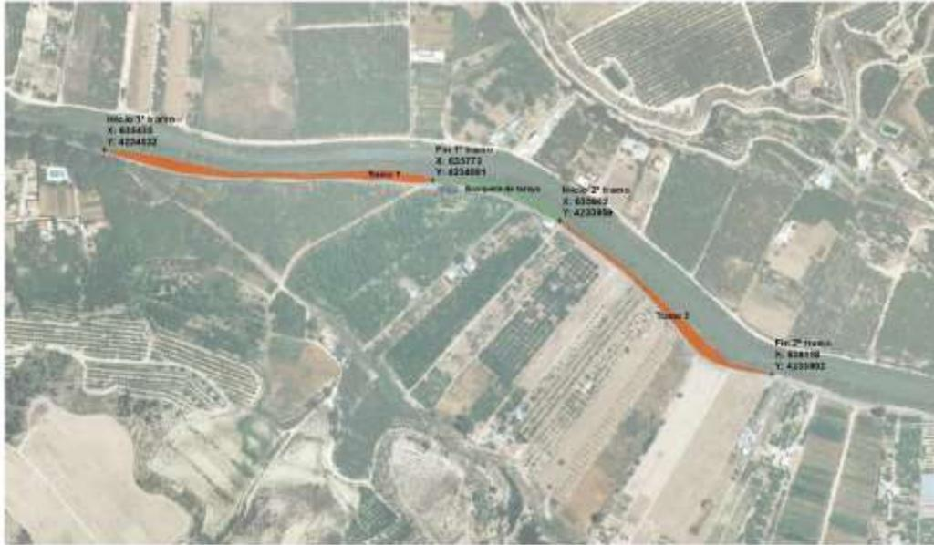
Imagen 1: Esquema de proyecto: Tramos de mota a eliminar y mantenimiento del bosque de tarays.
