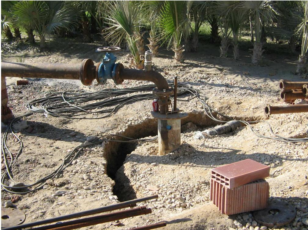
Fotografía nº 8. Grietas en el entorno de un pozo por vaciado de material con el agua bombeada en el aforo.
