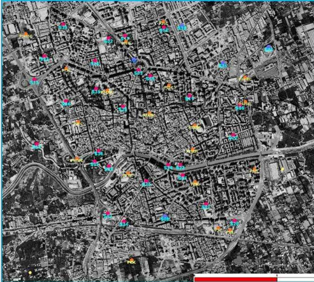
Figura nº 26. Imagen aérea que muestra la ubicación de los sondeos de EMUASA (puntos rosa con texto en azul) y los piezómetros CHS (puntos naranjas con texto en amarillo) en el centro de Murcia.
