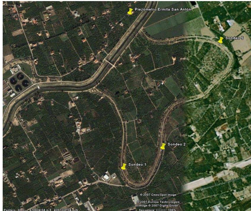
Fotografía nº 12. Distribución de sondeos de explotación en el entorno del piezómetro de la Ermita de San Antón
