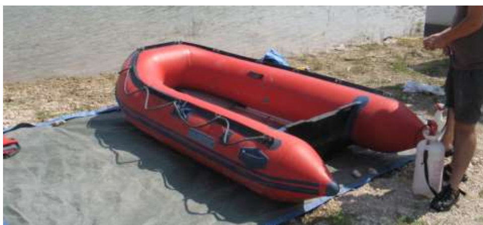
Desinfección con pulverización de solución de agua clorada
