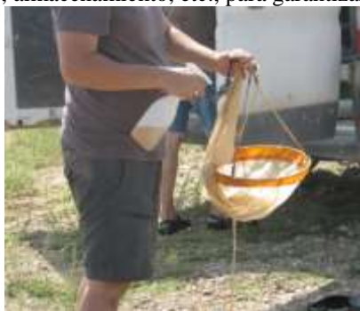
Desinfección de red de muestreo mediante pulverización de solución clorada
