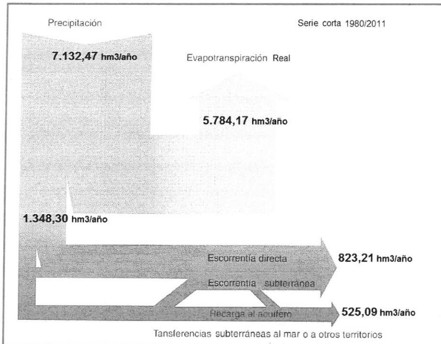
Figura 6. Los mismos componentes del ciclo hídrico en el Segura de la figura anterior calculados en volumen (hm<sup>3</sup>/año).
