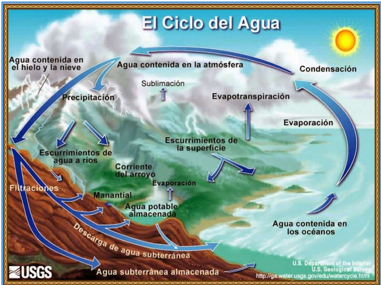
Figura 2 Esquema del ciclo natural del agua del USGS donde se ve en color marrón la parte del ciclo correspondiente a los recursos naturales de agua subterránea (descarga de agua subterránea) y al agua subterránea almacenada
