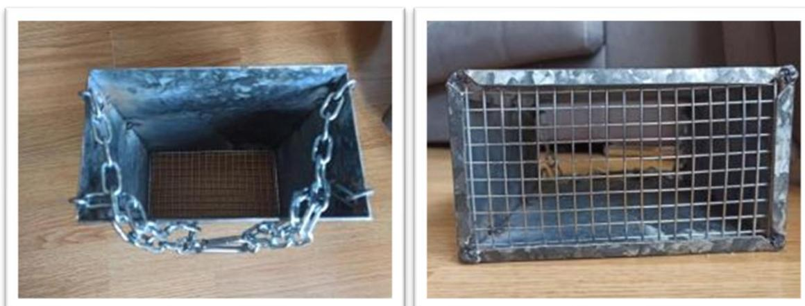
**Figura nº: 9.-** Draga de arrastre utilizada para la búsqueda de adultos de *Corbicula fluminea* en zonas de difícil acceso bien por el calado del agua en dicho punto o, por la velocidad de la corriente.
