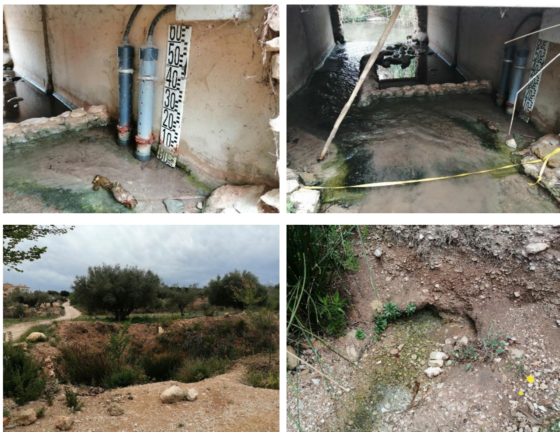
Foto 88. Vista general del entorno del Chícamo y detalle de la realización de un aforo de caudal y del telecontrol instalado
