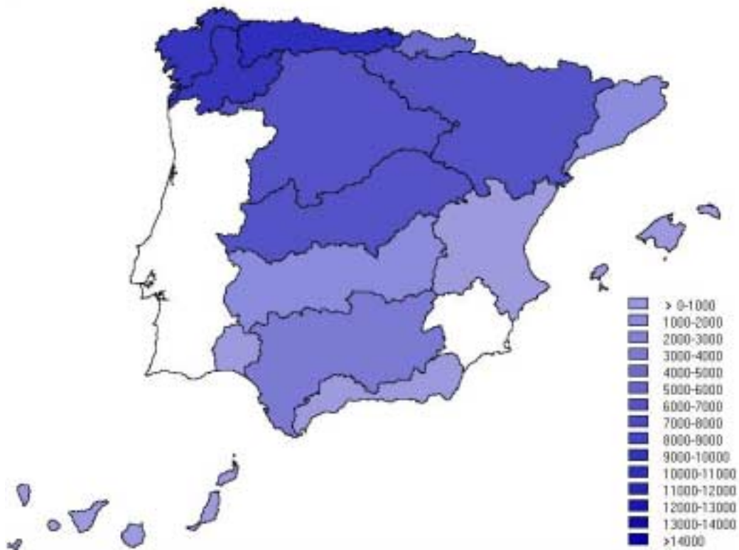
Figura 6. Mapa de superávit (hm 3 /año) en los ámbitos territoriales de los Planes Hidrológicos de cuenca considerando las demandas máximas previstas en ellos para el segundo horizonte
