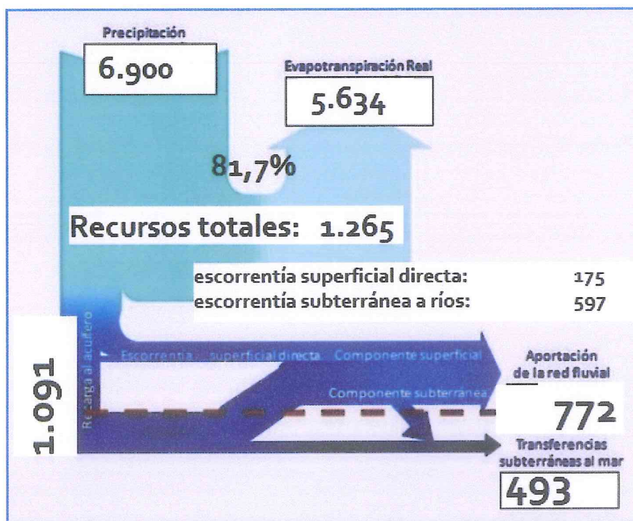
Figura 13.- Esquema de los componentes del ciclo hidrológico en régimen natural para el territorio de la DHS para la serie corta (80/81-08/09) con los datos del PPHDS. ETR: 81,7% de la Precipitación.
