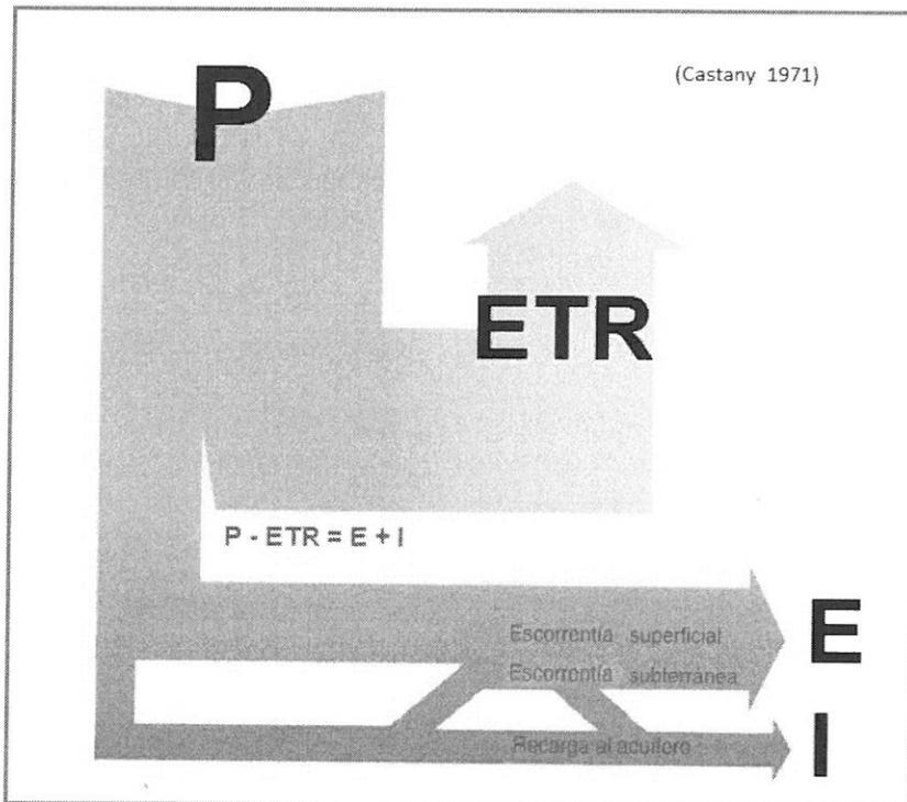
Figura 3. Esquema tomado del Libro Blanco del Agua (Ministerio de Medio Ambiente, 2001) y del Plan Hidrológico del Júcar 2009-2015 con las componetes del ciclo hídrico (Castany, 1971)
